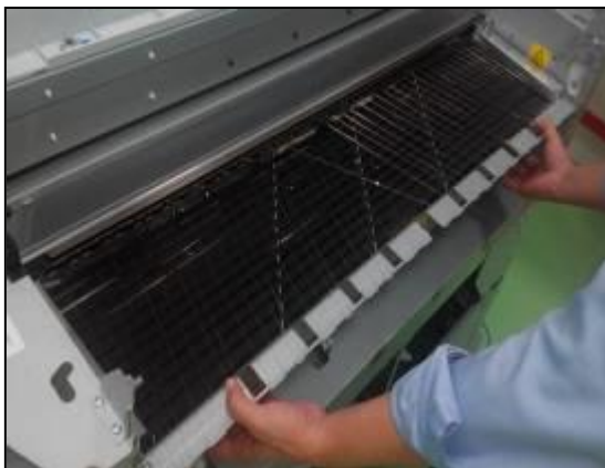
Remove Heater Unit.
